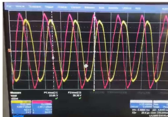
Fig.5. Oscilograma de las tensiones en las fases a 2.300 rpm en donde se aprecia la reducción de la tensión en la fase cargada con 0,6 A respecto a la que permanece en vacío.
